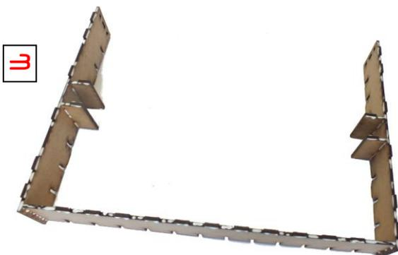
3 dann eine lange Seitenwand an die kurzen kleben. Die Schlitzte müssen alle in die gleiche Richtung zeigen.
