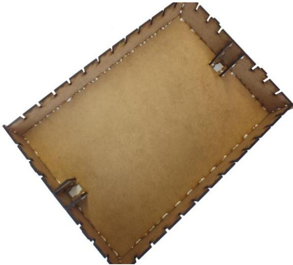
5 jetzt die ganze Konstruktion in die Schlitze der Bodenplatte einkleben, am Besten während der Kleber noch nicht getrocknet ist, damit es einfacher auszurichten ist.
