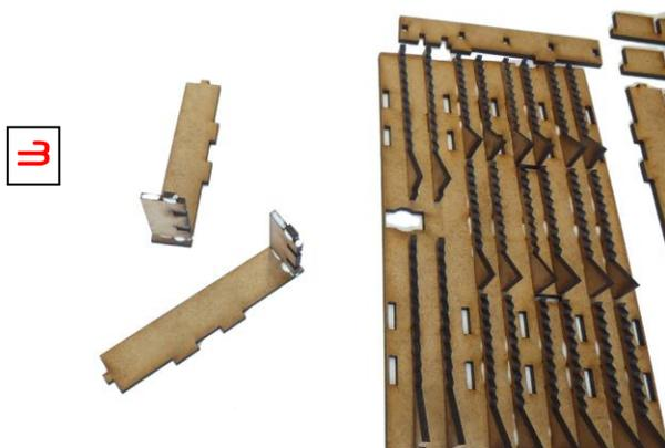
**3** Dann diese kleine Stücke in die kurzen Seitenwand teile einkleben.
