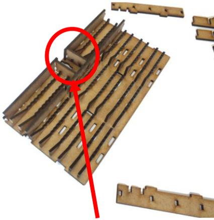
5 jetzt die ganze Konstruktion in die Schlitze der Bodenplatte einkleben, wo das große Loch ist. Am besten während der Kleber noch nicht getrocknet ist, damit es einfacher auszurichten ist.
