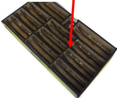
8 zuletzt die beiden Innenwände einkleben. Während der Kleber torcknet am Besten ein Gummiband aussen rum machen, damit die Seitenwände richtig angepresst sind.
