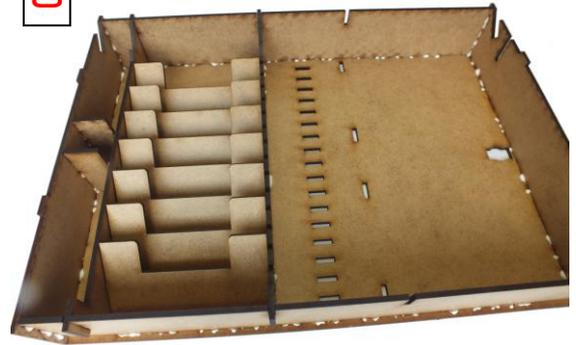
6 jetzt die ganze Konstruktion in die Schlitz der Bodenplatte einkleben, am besten während der Kleber noch nicht getrocknet ist, damit es einfacher auszurichten ist.
