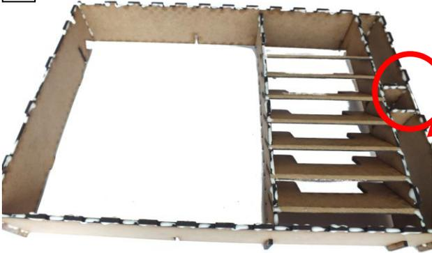
5 jetzt die kurzen Seitenwände einkleben. Die Wand mit 2 Schlitz auf die Seite mit Verbindungs-Schützern. Darauf achten, dass alle Nasen in die gleiche Richtung zeigen.
