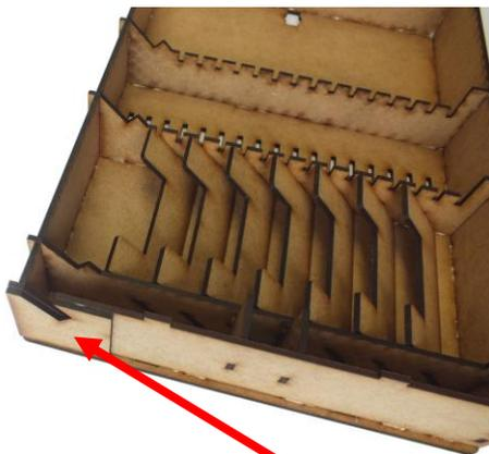
8 jetzt jeweils ein Teil mit schrägen Schlitz auf beiden Seiten von außen passgenau an die schrägen Schlitz in der Seitenwände ankleben.
