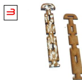
**5** Keine Kleberreste an den Kanten lassen! Diese wegwischen. **Mit Schraubzwingen oder 20 KG Gewicht darauf trocknen lassen. Minimale Toleranzen!** Notfalls etwas die Kanten abschleifen.
